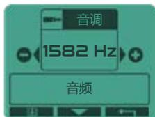
将脉冲模式的低/高频音调从100 Hz修改为1582 Hz。
