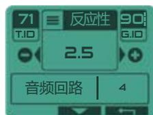
**DEUS II** 是一个快速和具有选择性的探测器！反应性是一个至关重要的设定，它决定着探测器的性能，分析被探测到的金属物体信号的速度以及对于位置比较靠近的两种金属物体的区分能力。如果土壤中含有大量的铁，热岩石或者其他矿化元素，那么对于土壤的穿透性会降低。这种情况下，您可以选择高反应性，这样可以更快速地分析金属信号。另一方面，如果土壤是干净的，最好也将反应性调节降低，扫描速度也放慢一些，这样可以使得探测器对于较深的群聚金属物有更高的灵敏度，并且对于土壤会有更强的穿透性。在海滩上，由于目标通常彼此远离，因此低反应性水平（如0或1）将非常有效。但是，如果你遇到棘手的情况，例如由磁性黑砂构成的污染海滩或盐度可变的海滩，则将反应性增加到2.5或3，从而变得更具选择性和更稳定，这将使你更容易分析目标。
