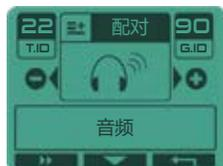
**自动:** 如果没有无线耳机配对，请在启动遥控器时选择无线耳机图标。按耳机模块上的 **键** 两秒钟遥控器将邀请您配对。
