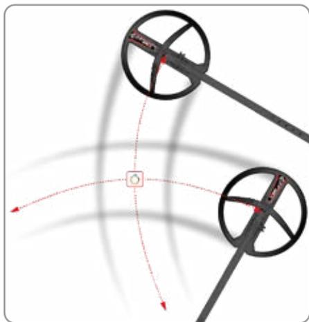
当探测器测到了金属目标的大概位置，而且是在移动探测中找到的信号，如果您想要精准定位，就将探测盘再次在刚才报警的地方扫过，找到这个声音。
