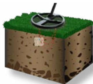
将探测盘放置在没有金属的位置，离地面2-5公分，然后按
