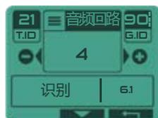
音频回路可以放大深层目标的音量，这样探测器对于它们会更加警觉。它给出了一个更大功率的感觉，能够更清楚地听到深层目标的信号。
