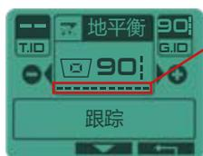
● 矿化强度. 读条值越高, 土壤的矿化程度就越高。将探测盘对着地面, 进行上下抽送看下矿化的强度。
