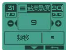
除常规灵敏度设置外, «盐灵敏度»设置还具有减少通常与海水有关的虚假信号的优点, 而常规灵敏度作用于所有目标和所有信号。在搜索潮湿海滩或海底冲浪时, 始终优先使用盐灵敏度设置, 而不是常规灵敏度。常规灵敏度应当是机器受到来自电磁干扰 (EMI) 的情况下使用的。
