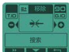
想要在不使用 **DEUS II** 的情况下使用MI-6，请在MI-6菜单上选择程序1至6。要更改程序：打开MI-6开关。按下按钮5秒钟，音频蜂鸣音表示您已进入程序选择模式。按以对应所需的程序编号（例如，按两下程序2）。2秒钟后，音频蜂鸣音表示MI-6已返回搜索模式。
