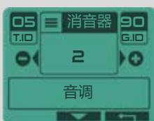
一些大的铁金属物体或者不规则形状的金属物体很难识别出来。通常遇到铁金属物体会发出几声碎裂声，或者不一致的信号声。当您增加消音装置的等级，就可以过滤排除因为铁金属造成的碎裂杂音。
