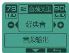
DEUS II 为您提供广泛的声音和声音偏移选择。根据您的喜好和周围环境，您可以使用完全不同的音频类型。例如，某些音频类型将通过软化干扰引起的低信号更好地适应棘手的污染地面，而其他音频类型将通过根据目标深度或大小混合不同声音的动态比例更好地识别目标距离。
