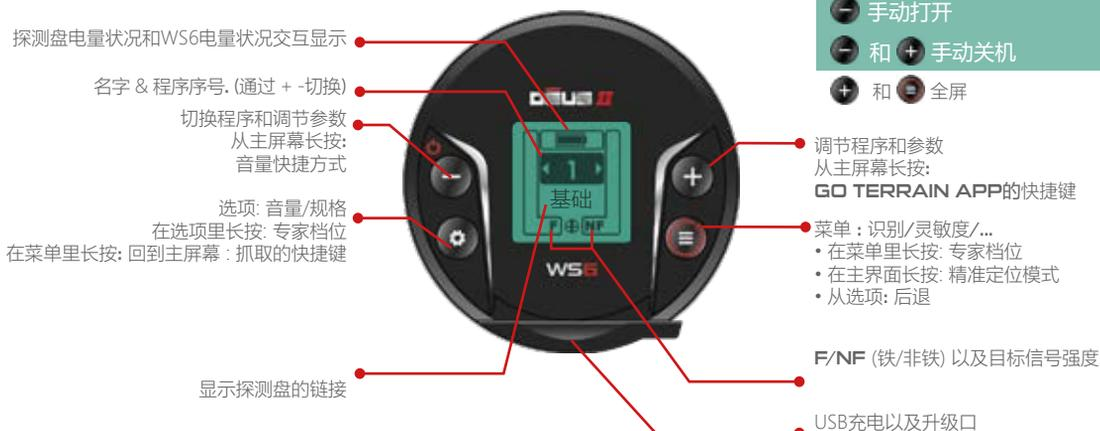
遥控主机程序与内部WS6程序是分开的。当独立使用WS6作为主控设备（无遥控主机）时，WS6会找到其默认原始的用户程序，遥控主机的程序不会传输到WS6。
