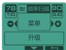
此功能激活检测频率的自动扫描，并在每次节目更改或单声道节目中的每次频率更改时指示干扰最小的清晰频道。频率扫描在**DEUS II**上速度特别快，但会使更改程序时导航速度降低2秒。
