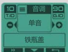
Pitch沥青模式不同于其他的模式, 它不会顾及金属目标的传导性: 信号的长度生成的音频信号随着振幅和高度(频率)变化而变化。目标的深度越深, 生成的就是低程度音频, 声音比较微弱。越近的金属目标, 生成的就是高程度音频, 声音比较强。音高模式可以给出“特色”的信号, 可以用来定位目标。这也使得探测器似乎有了更多的反应。但是, 它对于探测器的反应性没有影响, 只是影响音频。沥青音的低音到高音可从150 Hz到603 Hz之间选择。
