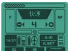
标准多信息显示，目标指数用粗体+F/NF（铁/非铁）图表示，也表示评估深度的目标强度。
