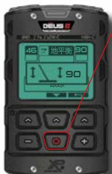
在任何菜单下, 你可以随时通过按住 **[G.B]** 按键并且同时对着地面土壤上下抽送探测盘直到地面音频信号减弱并且数值稳定。
