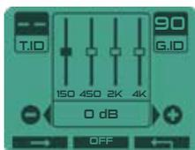
除了简单的低/高频设置外，均衡器还可以在四个频段上校正扬声器和耳机的声音，使其与您的听力偏好相匹配。因此，您可以将低音设置为150 Hz左右，中低音设置为450 Hz左右，中高音设置为2000 Hz左右，高音设置为4000 Hz左右。
