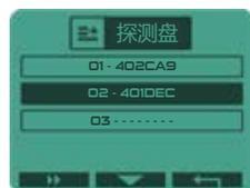
在使用过程中关闭探测盘灯和无线耳机: 选项 > 探测盘匹配, 选择与之相反的探测盘, 然后按
