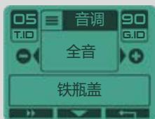
全音调识别模式会给每一个金属目标代码生成略微不同的音调。金属目标的传导性越高，ID数值就越高，音调就越高。
