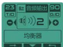
用无线耳机来听声音不用遥控主机听声音的话遥控器可使用电量时间在30小时左右，但如果使用遥控主机扬声器或者BH-01耳机时，即使音量等级在1级，电池电量会下降到15小时。通过将未使用的输出移动到0以延长电池寿命，禁用未使用的输出。
