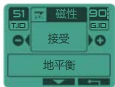
在磁性地面（如黑砂）探测时，深层目标可能会因为它们的值与土壤值相似而被掩盖。磁性地面设置允许您接受由地面、铁氧化物、陨石以及通常被遮蔽的远距离目标产生的低音。
