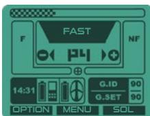
Affichage standard multi-informations, avec l'indice des cibles en gros + le graphe F/NF (ferreux/non ferreux) indiquant aussi la force de la cible pour une appréciation de la profondeur.
