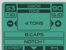
Pressez **MENU** > **DISCRI** > **EXPERT**. Choisissez **2 Tons - 3 Tons - 4 Tons - 5 Tons**. Pressez **EXPERT** et accédez à l'écran MULTI TONS.
