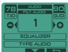
Ce filtre nettoie l'audio et rend les sons plus doux, lissés et moins crachotants particulièrement en limite de profondeur où vous gagnerez quelques centimètres de performance.
