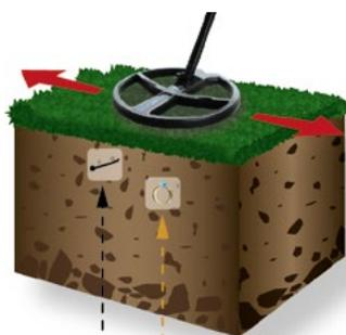
Ex. Passage du disque sur un ferreux proche de la surface puis sur une cible de métal noble (bague).
