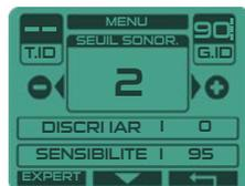
Cette fonction permet de régler l'amplitude du seuil sonore de fond. Les cibles rejetées génèrent une coupure de ce seuil sonore.
