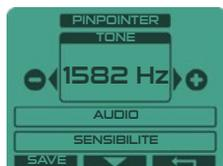
Modifiez la tonalité audio grave/aigu du mode PULSE de 100 à 1582 Hz.
