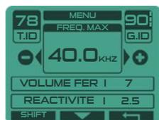
Pressez **-** ou **+** pour sélectionner une des 3 fréquences maximales.
