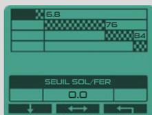
Dans MULTI TONS, pressez **↓** jusqu'au Seuil Sol/Fer puis ajustez le de 0.0 à -6.4.
