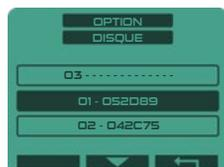
Pour éteindre la LED du disque et du casque sans fil pendant l'usage: Dans OPTION > Appairer DISQUE, sélectionnez le disque de votre choix comme ci-contre et appuyez 4 secondes sur la touche . A l'extinction, ce mode se désactive et les LED re-fonctionneront normalement.
