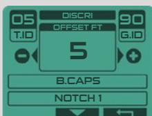
Le réglage OFFSET FT décale les fréquences audio vers l'aigu des premières cibles ayant une signature juste au-dessus du seuil de Discrimination, afin de mieux les différencier auditivement des ferreux.
