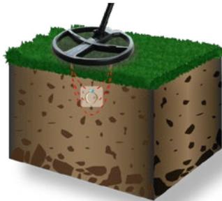
Allez sur la cible pour la localiser. Le signal le plus fort et aigu indique la position de la cible au centre du disque.
