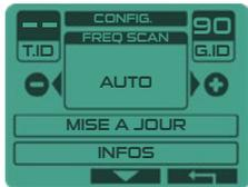
Cette fonction lance une recherche automatique de la fréquence de détection la moins parasitée à chaque changement de programme ou chaque changement de fréquence principale dans le programme MONO. Le scan de fréquence automatique est particulièrement rapide sur le **DEUS II**, cependant il ralentira de 2 secondes votre navigation lors de changement de programme.
