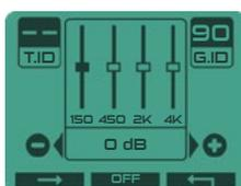
Au-delà d'un simple réglage audio grave/aigu, l'Equalizer permet de corriger l'acoustique des casques sur 4 bandes afin de l'adapter à vos préférences auditives. Vous pouvez ainsi régler les graves autour de 150Hz, les bas médiums autour de 450Hz, les hauts médiums autour de 2000Hz et les aigus autour de 4000Hz.
