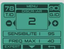
Les programmes 8 GOLD FIELD et 9 RELIC utilisent un traitement et une discrimination spécifique IAR (Iron Amplitude Rejection). Celle-ci permet de rejeter les ferreux en fonction de leur distance.
