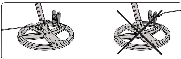
La conexión de la pinza debe estar orientada hacia el centro del plato.
